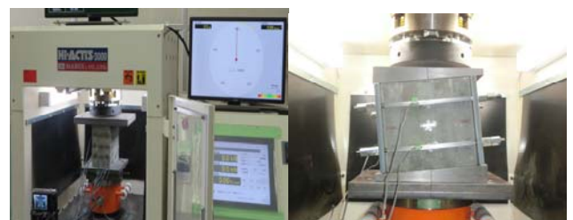
写真-2(左) 圧縮試験機と試験体設置状況(3_00_N)
