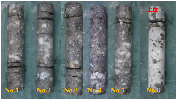
写真-2 採取したコアの折損状況露出状況
