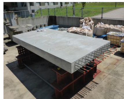
写真－1 プレキャスト PC 床版試験体の
