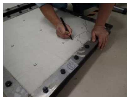
図-2 ひび割れ測定状況
