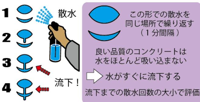
図 1 散水試験 A 法
