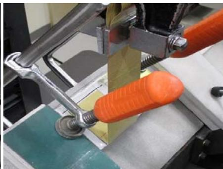
写真-2 見かけの剥離抵抗性試験
