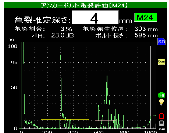
写真-3 亀裂点検表示画面
