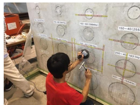
Fig-1 円形空洞試験体による学習状況
