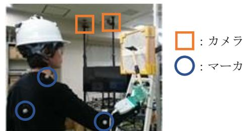
図-3 打音点検動作測定試験の様子
