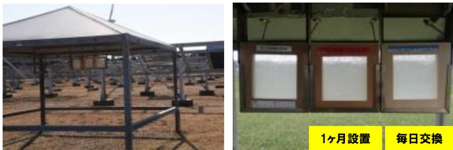
図1 ドライガーゼ法による飛来海塩量の測定；
