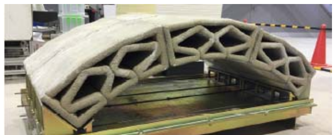
写真-2 モルタル積層断面の例（13層）
