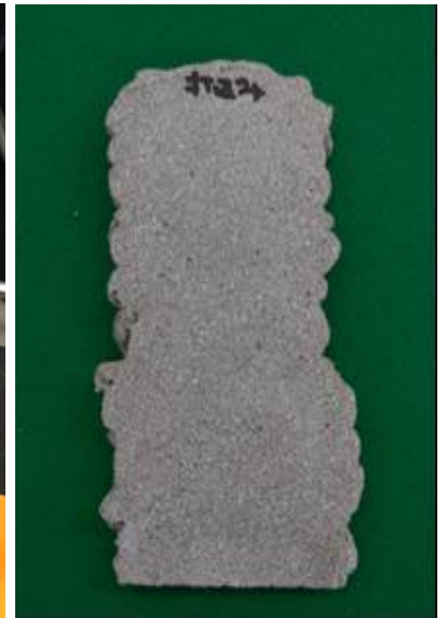
写真-2 モルタル積層断面の例（13層）
