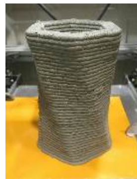
写真-2 小型試作機を用いた製作物の一例
