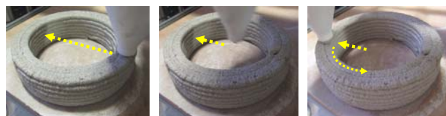
写真-5 不連続区間の空中移動
