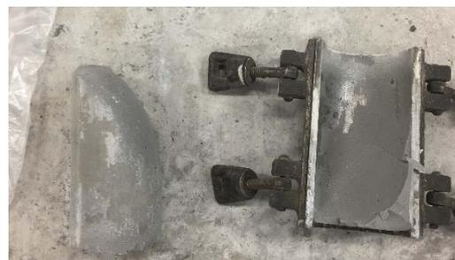
写真1 脱型時に破壊した供試体の一例
