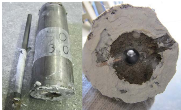
写真-2 引抜き実験後の供試体破壊状況
