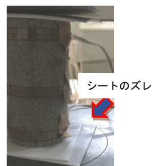
図-6 シート厚 1.0mm の試験不能状況 (1.0-1)
