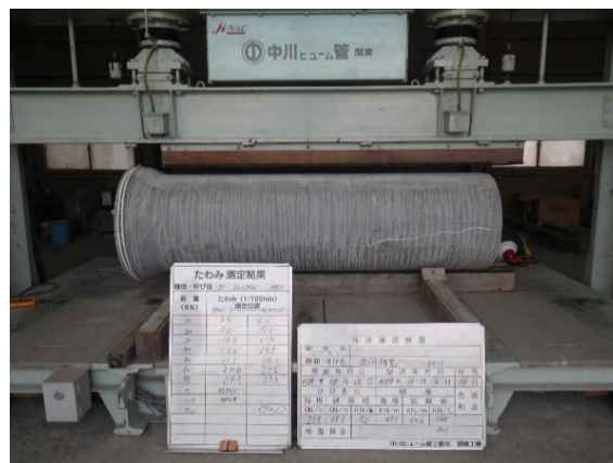
写真1 外圧強さ試験状況 (BBSF)
