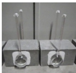
写真-1 吸水試験状況
