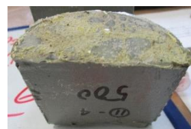
写真1 ゲルを塗布した試験体
