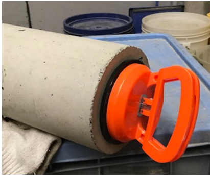
図1 吸引カップを設置した様子
