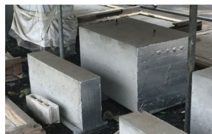
小型壁、梁試験体
