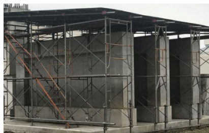
実大壁試験体
