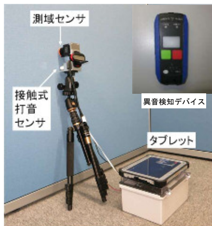
図-3 開発した計測ユニット
