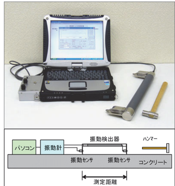
図-1 聴強器と計測概念
