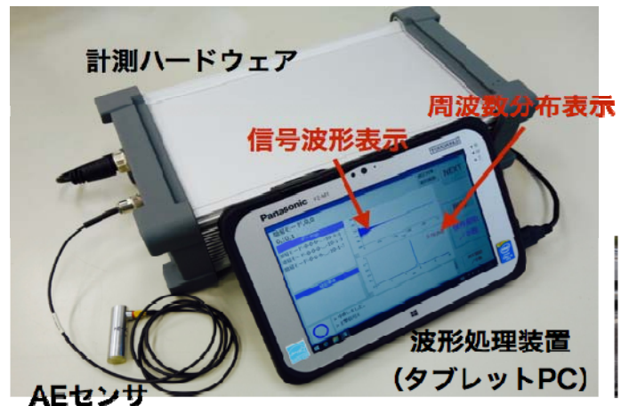
図 1 AE センサを用いた打音検査装置
