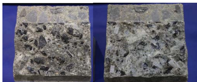
図-4 注入剤 A-① (初期ひび割れ 0.3 mm)
