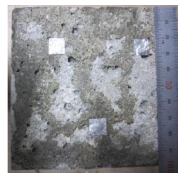
図-5 浸透性試験例 (エポキシ1層目のみ)
