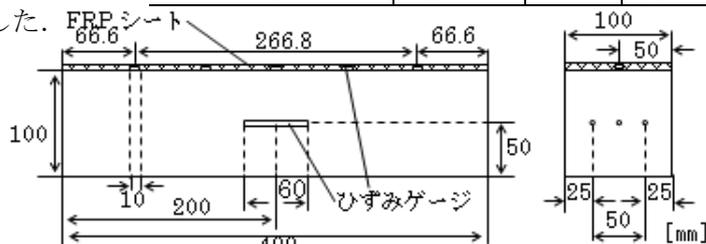
図-1 供試体の詳細寸法図
