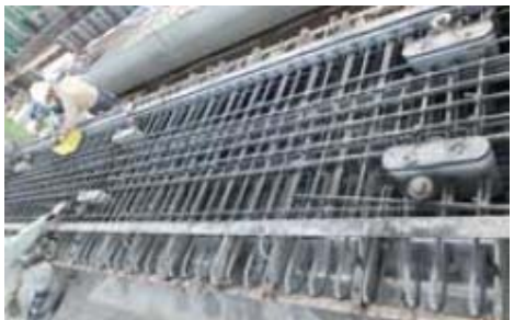
写真-2 SC ストランド使用の高耐久性プレキャスト PC 床版の製作
