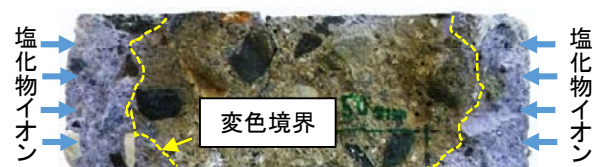
図-1 硝酸銀溶液の噴霧による塩化物イオンの浸透状況の確認例
