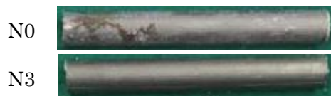
写真 1 鉄筋腐食状況
