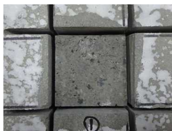
(b) PCM と母材コンの界面破壊
