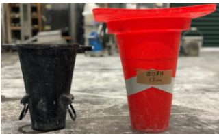
写真-1 逆コーン試験器
