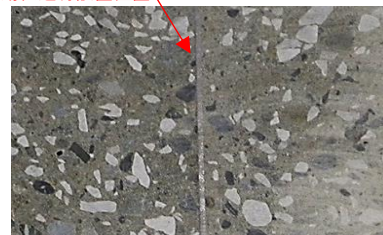
写真-1 供試体切断面
