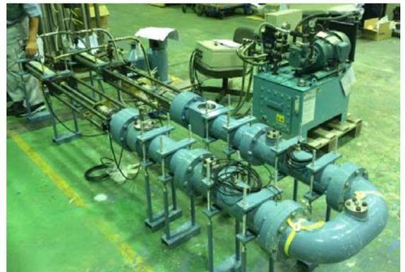
写真-1 ポンプ圧送性試験装置
