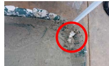
写真2 水溶性紙袋の溶け残り
