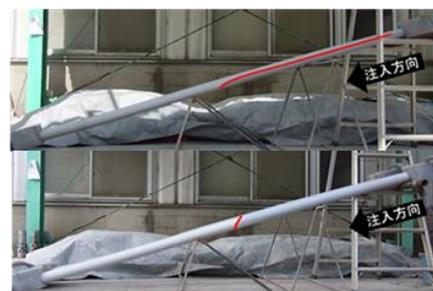
図 6 市販品(上)と開発品(下)を充填した時の実験の様子
