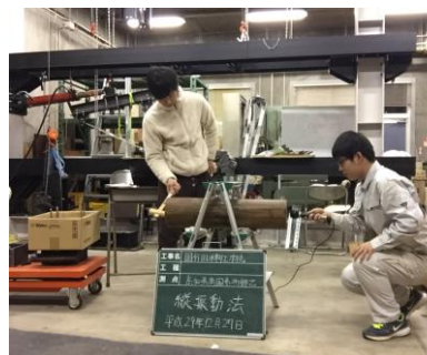
写真-2 縦振動法実施状況
