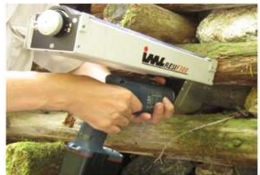
写真2 レジストグラフによる木材劣化厚の測定
