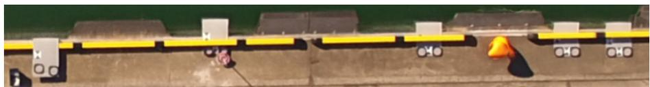
図-4 図-3の模型設置範囲を拡大(右から水平変位5, 10, 20, 50cm, 鉛直変位)
