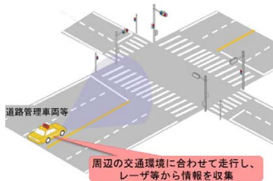
図1 車両搭載センシング技術のイメージ
