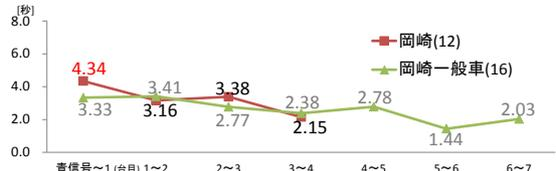
図-7 自動運転車が1台目(先頭車両)の場合の車頭時間比較
