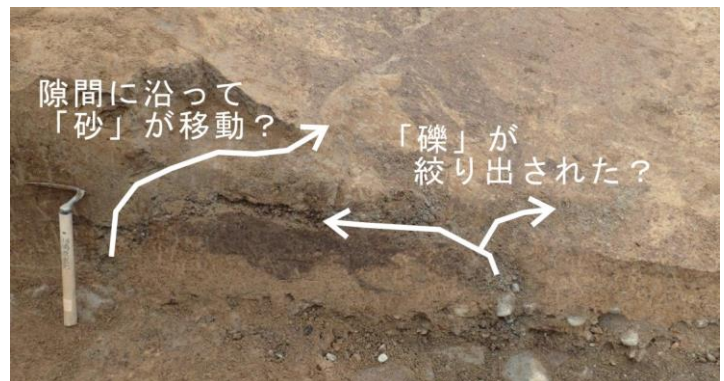
図-2 地割れの間隙を下方から充填する砂の例。
