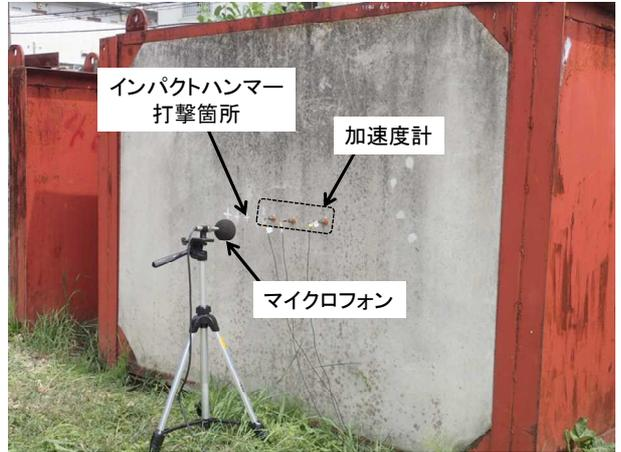
図1 打音試験の概要<sup>1)</sup>
