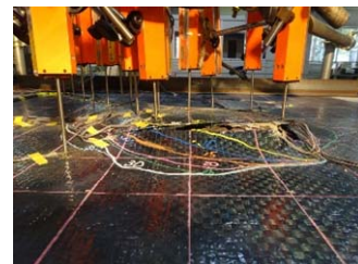
写真-2 シート損傷状況
