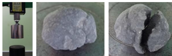
図5 載荷板と破碎試験前後の粒子
