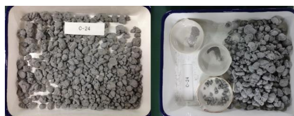
a) 乾湿繰返し前 b) 乾湿繰返し後 図1 乾湿繰返し前後の粒子の状態(ケース A-5)
