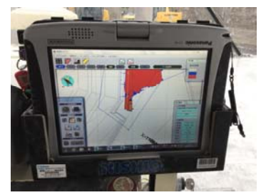
図-6 GNSS による 施工範囲の表示
