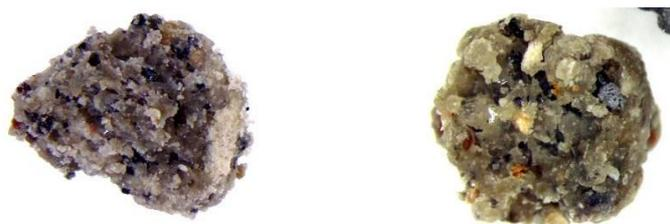
写真5 袋振り混ぜで製造した試料断面 (w=22%)
