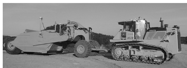
写真-1 被牽引式スクレーパ（ブルドーザ牽引）
