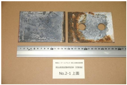
写真-2 不純物除去後の供試体 (NO. 2-1)
