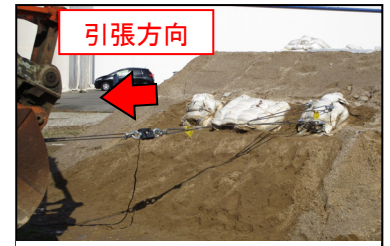
図-4 引抜き試験状況
