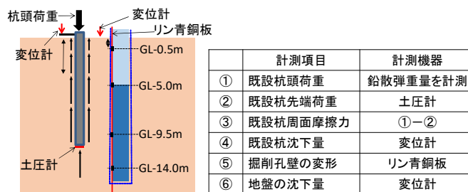
図2 計測項目と計測機器
