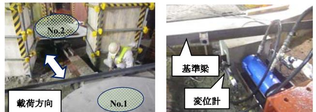
写真 1.1 試験全景(場所打ち杭) 写真 1.2 変位計設置(場所打ち杭)
