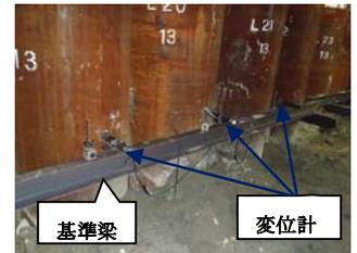
写真 1.4 変位計設置 (鋼管杭)
